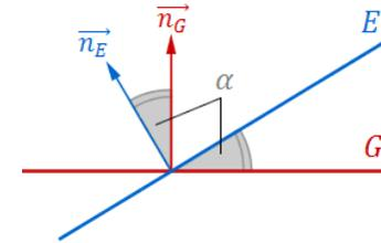
Der Winkel  $\alpha$  zwischen zwei Ebenen  $E$  und  $G$  ist gleich dem Winkel zwischen den Normalenvektoren  $\vec{n}_E$  und  $\vec{n}_G$ .
